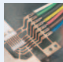
Litzen und Flachband für die Steuernabe eines Automobils werden auf ein Stanzgitter geschweisst.
